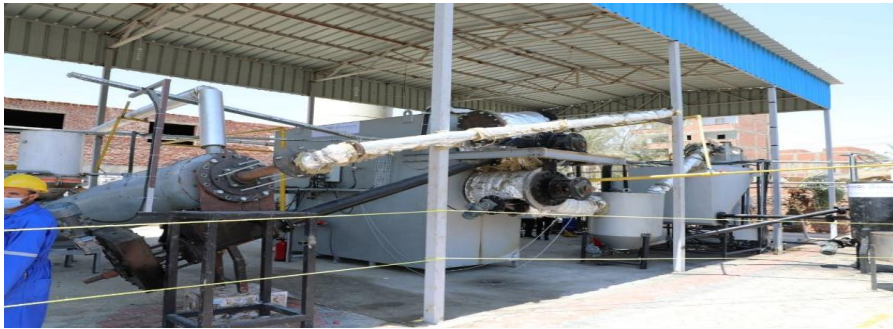
صورة (٢) : وحدة التغويز اللاهوائي بمصنع قلهانة بمركز اطسا
